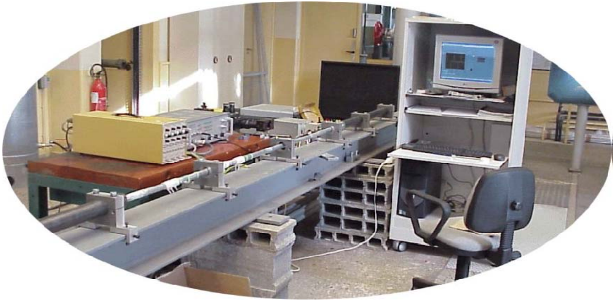
Figure 1.17: Le dispositif à barres d'Hopkinson [31].
