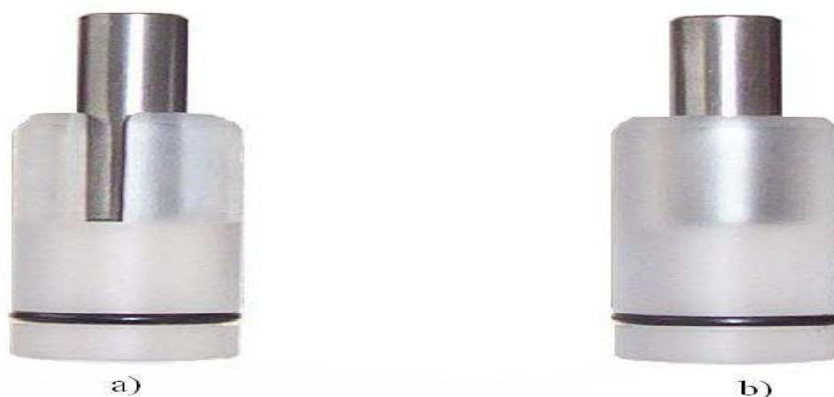
Figure 1.12: Projectile équipé de son sabot [26].
