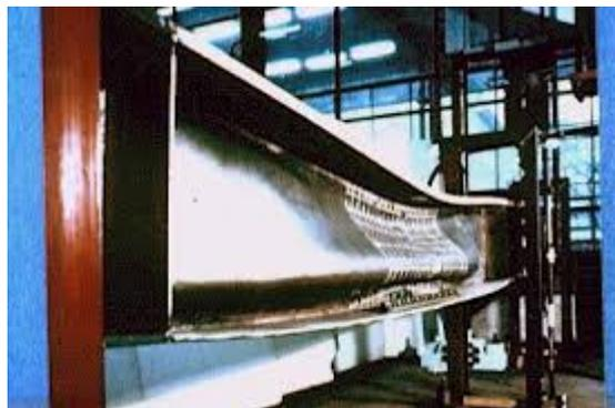
Figure 3 : Flambement d'une plaque
