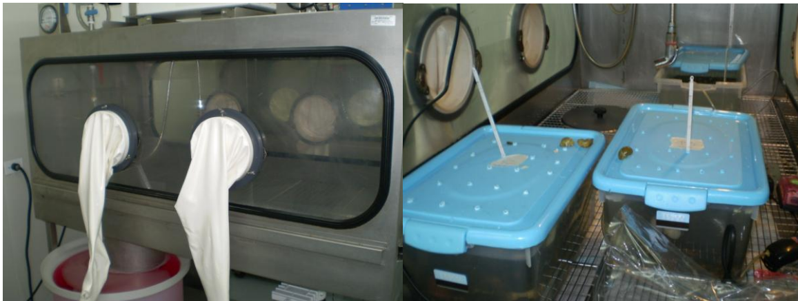
Figures 9 : Mise en place des bacs dans l'isolateur à volailles.
