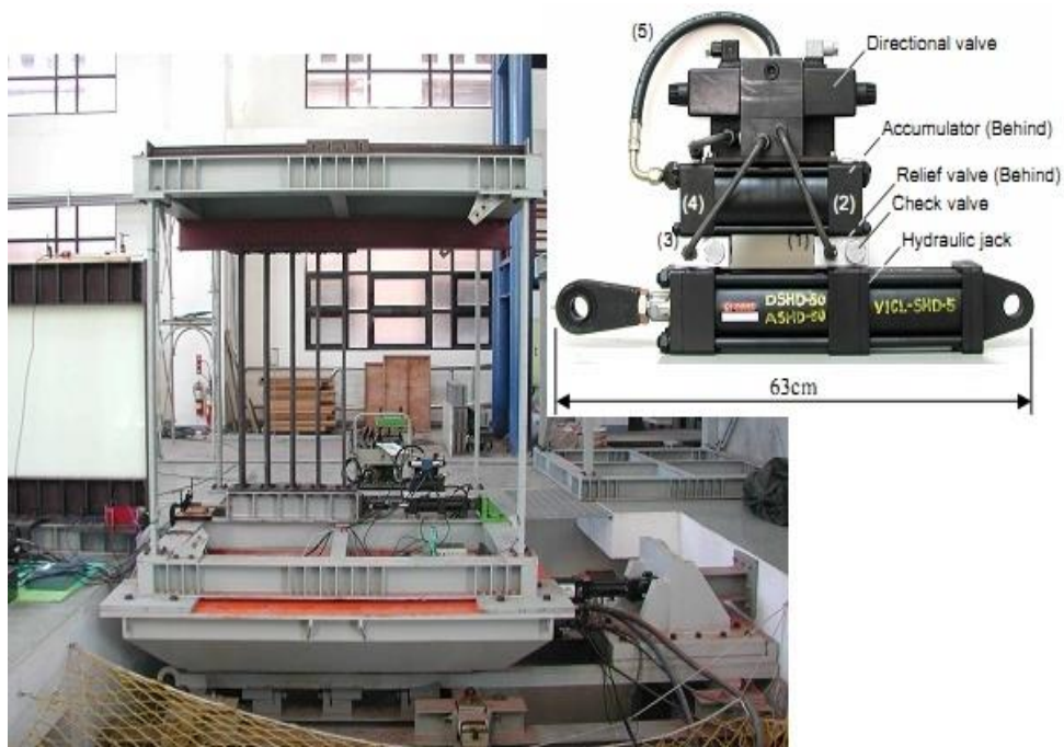
Fig 2.24 Essai de la table vibrante d'un amortisseur hydraulique semi-actif.
