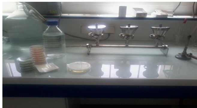
Photo : Méthode de filtration sur membrane
