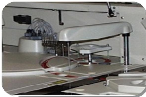
**Photo n°6 : la seringue de distribution de l'échantillon**
