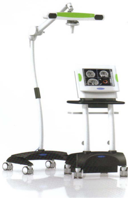
Figure 11 : Système de neuronavigation neuronavigation (caméra et IRM volumique)
