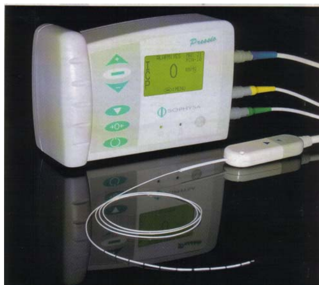
Figure 6 : Système de monitoring de la pression intracrânienne (60).
