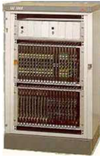
Figure A1: Autocommutateur privé ou PABX
