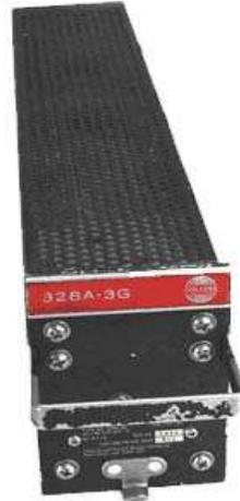
**Figure I-1- 18: Amplificateur d'asservissement**
