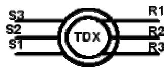
Figure I-1-31: Transmetteur différentiel de couple
