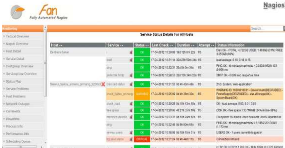
Figure 42 : Interface des services supervisés dans Nagios
