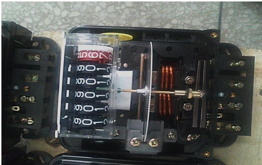
**Figure 6 : le compteur monté.**
