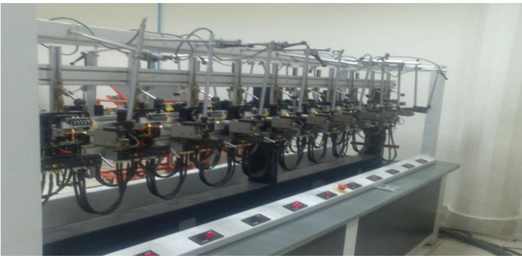
**Figure 12 : contrôle la qualité des compteurs.**
