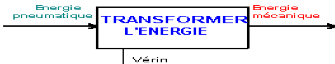
Figure 17 : Rôle du vérin
