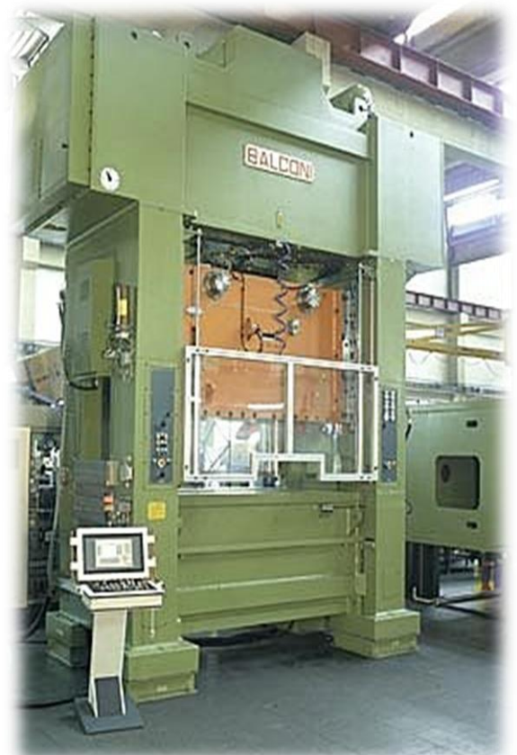
Figure II.6 : presse de découpage
