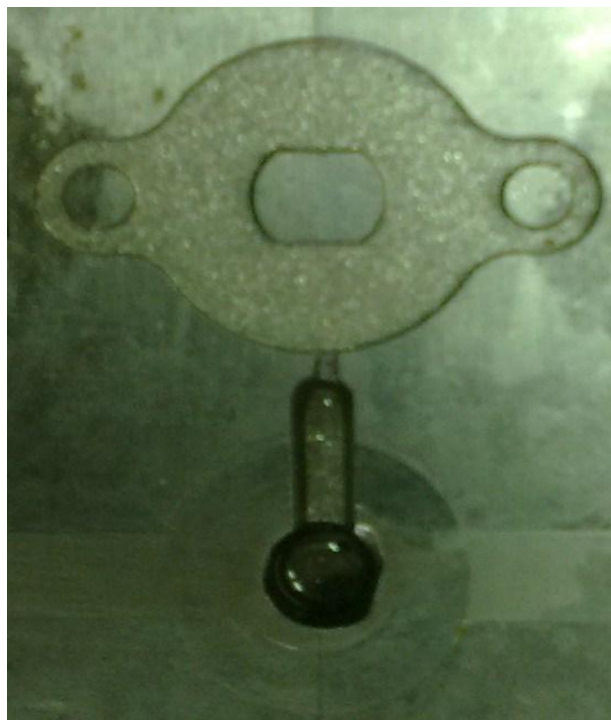
Figure IV.2: empreinte du moule réalisant le joint TV prototype
