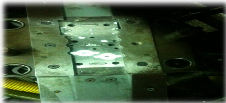
Figure II.5 : partie inférieure de l'outil
