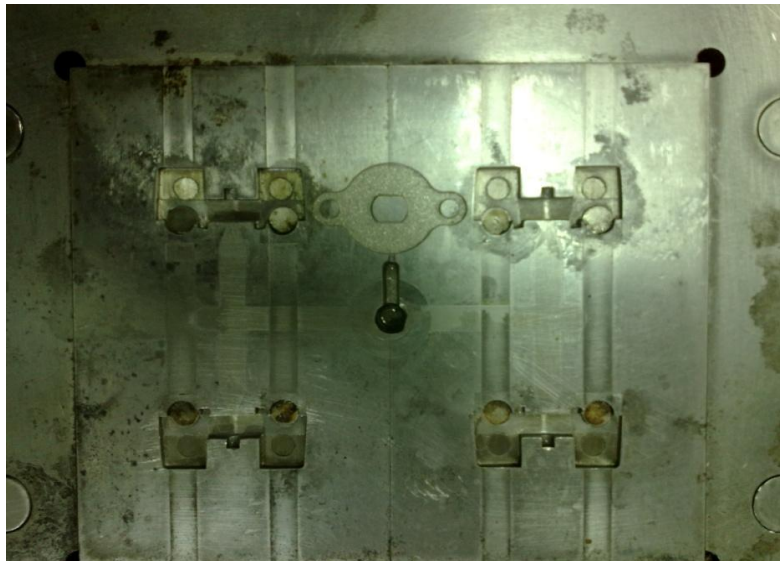
Figure IV.1: empreinte du moule non utilisé
