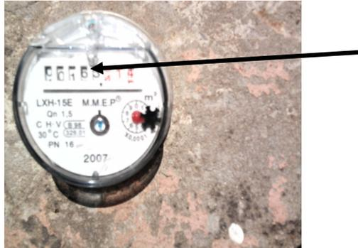
*FIG.12-2. Totalisateur du Compteur MMEP DN 15 détraqué*
