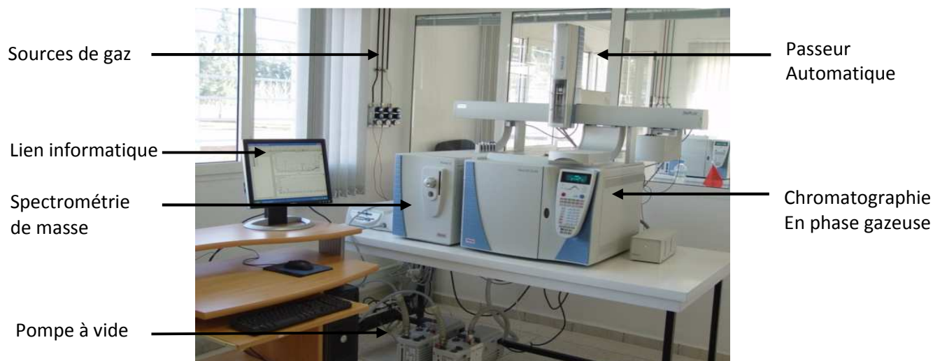
Photo 3 : Chromatographie en Phase Gazeuse Couplée à la Spectrométrie de Masse (GC/MS) (CURI)
