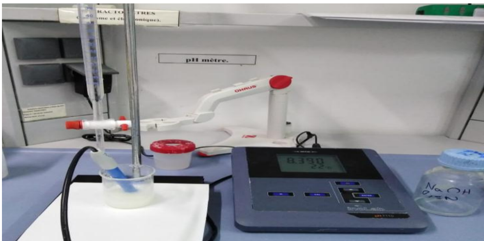
Figure 5 : Méthodologie de l'acidité titrable
