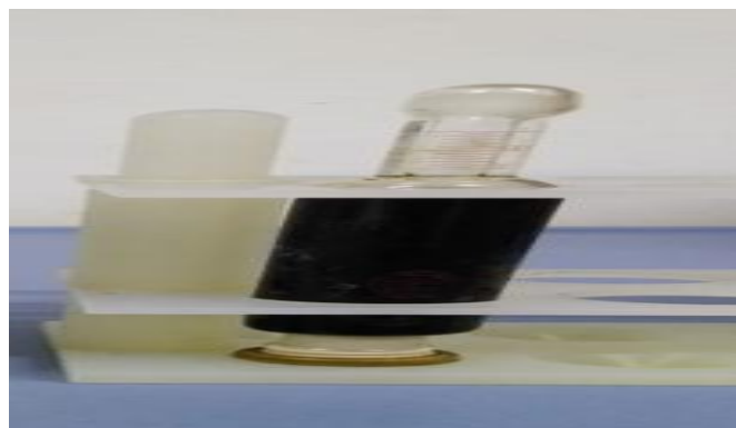
Figure 3: la séparation de la MG du lait écrémé dans le butyromètre à double volume (absence de MG).
