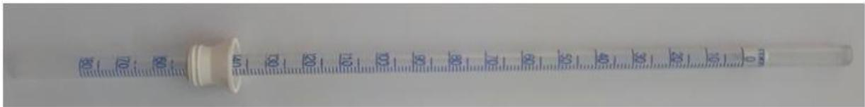
**Figure 9** : Tube Westergren : sous forme d'une pipette graduée de 0 à 170 mm.
