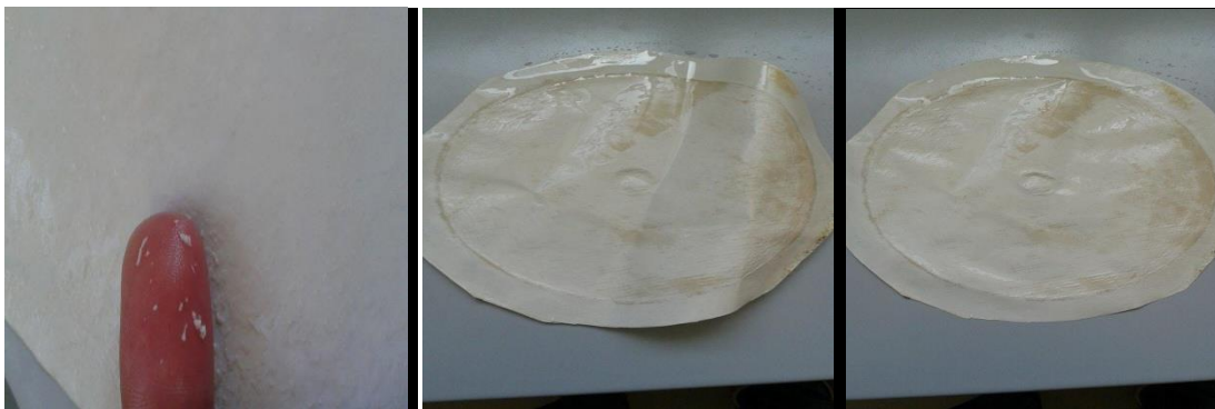
Figure 16: dégradation de la membrane recyclée par NaOH
