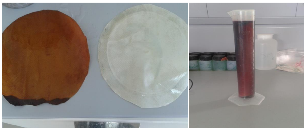
Figure 12: membrane apres et avant recyclage par \text{KMnO}_4
