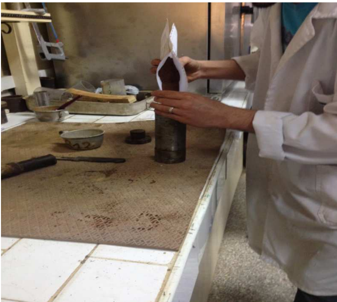
Photo. II.21 : Préparation de l'échantillon pour le compactage.
