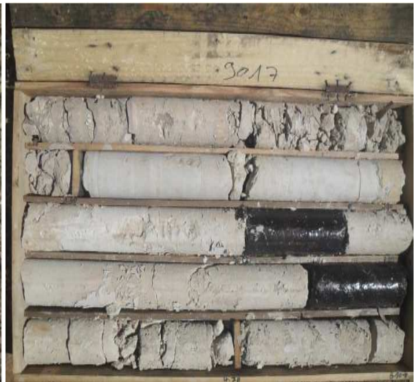
Photo. II.2 : Echantillon intact prélevé par carottage.
