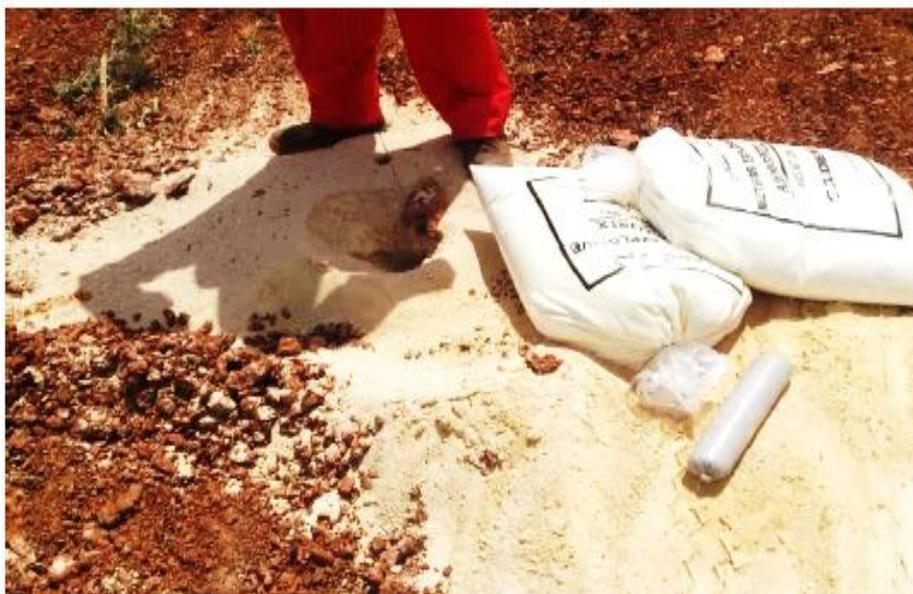
*Figure 17:les produits d'explosif utiliser par Holcim (Ammonix, Tovex et Amorce électrique)*
