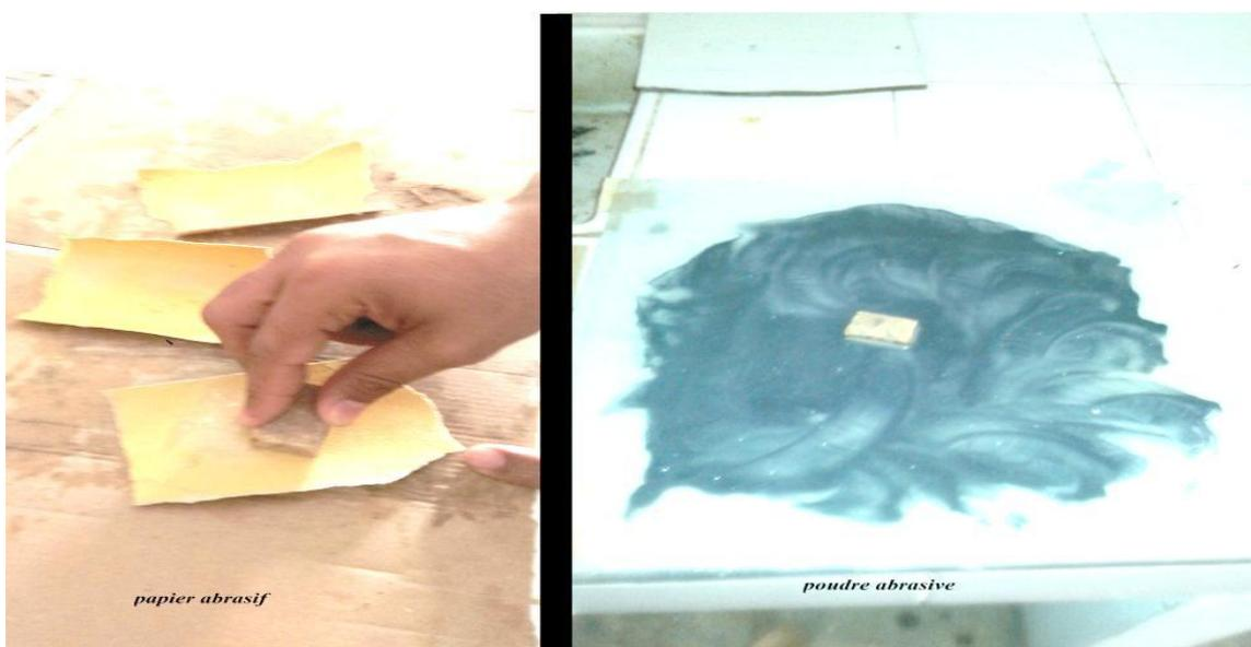
*Figure 22: rectification des surfaces*
