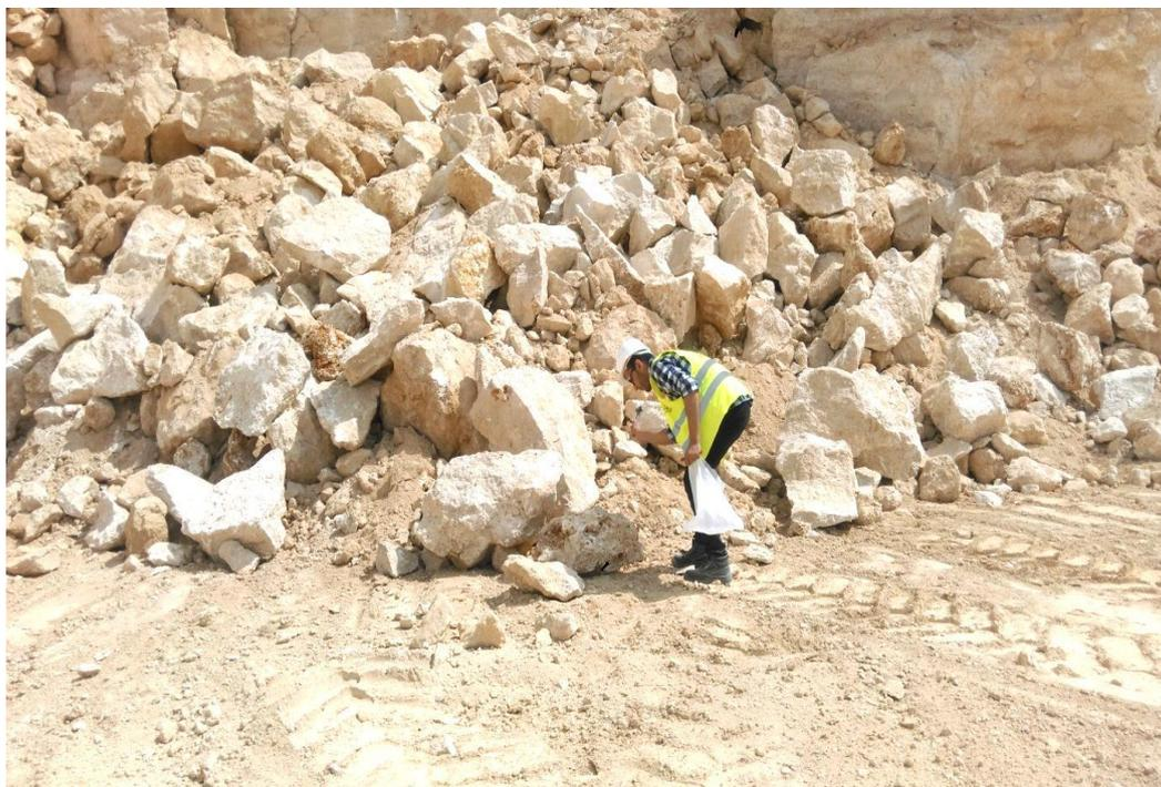
*Figure 18:prélèvement des échantillons à partir des gradins de la carrière*
