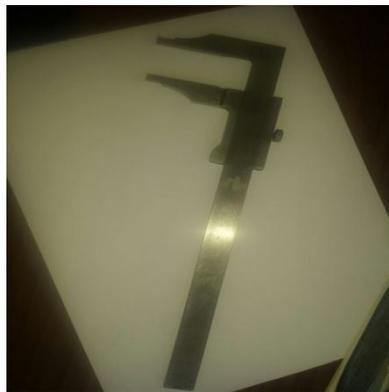
**Figure 7 :** Pied à coulisse utilisé dans nos mesures.
