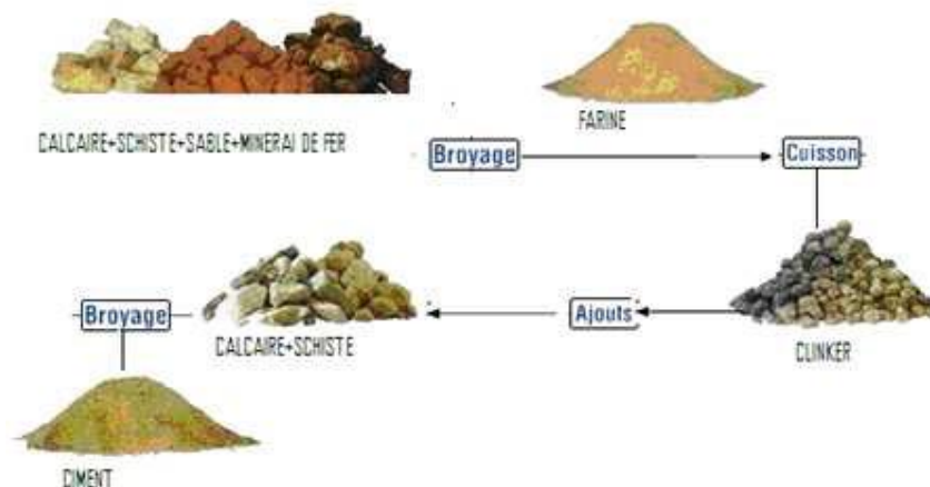
Figure 4 : chaîne de transformation du calcaire et d'argile au ciment
