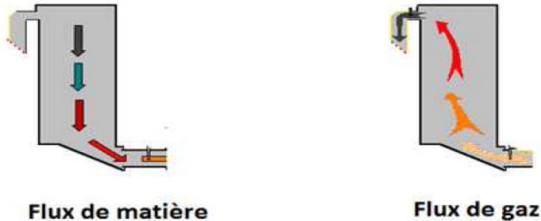
Figure 9 : entrée flux de matière, entrée gaz
