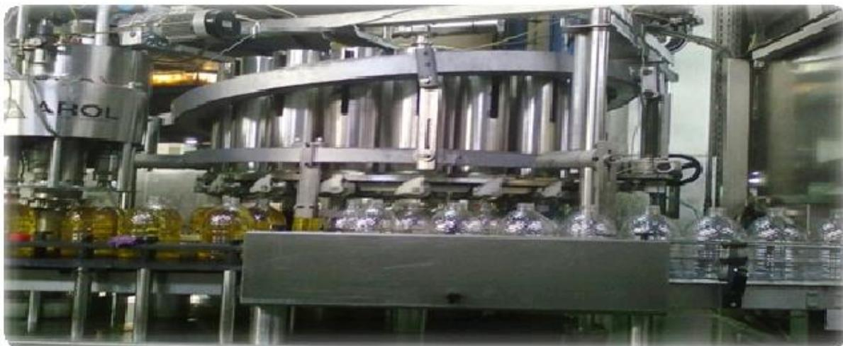
**Figure 7 : La remplisseuse/boucheuse.**
