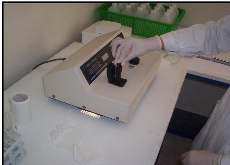
Figure I. 25 : La lecture à l'aide du spectrophotomètre.
