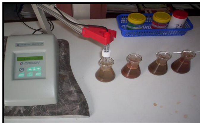
Figure I.21 : Mesure du pH du sol a l'aide de pH mètre.
