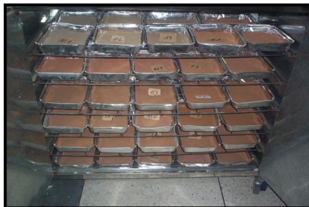
Figure I.12 : Séchage des échantillons dans le four.
