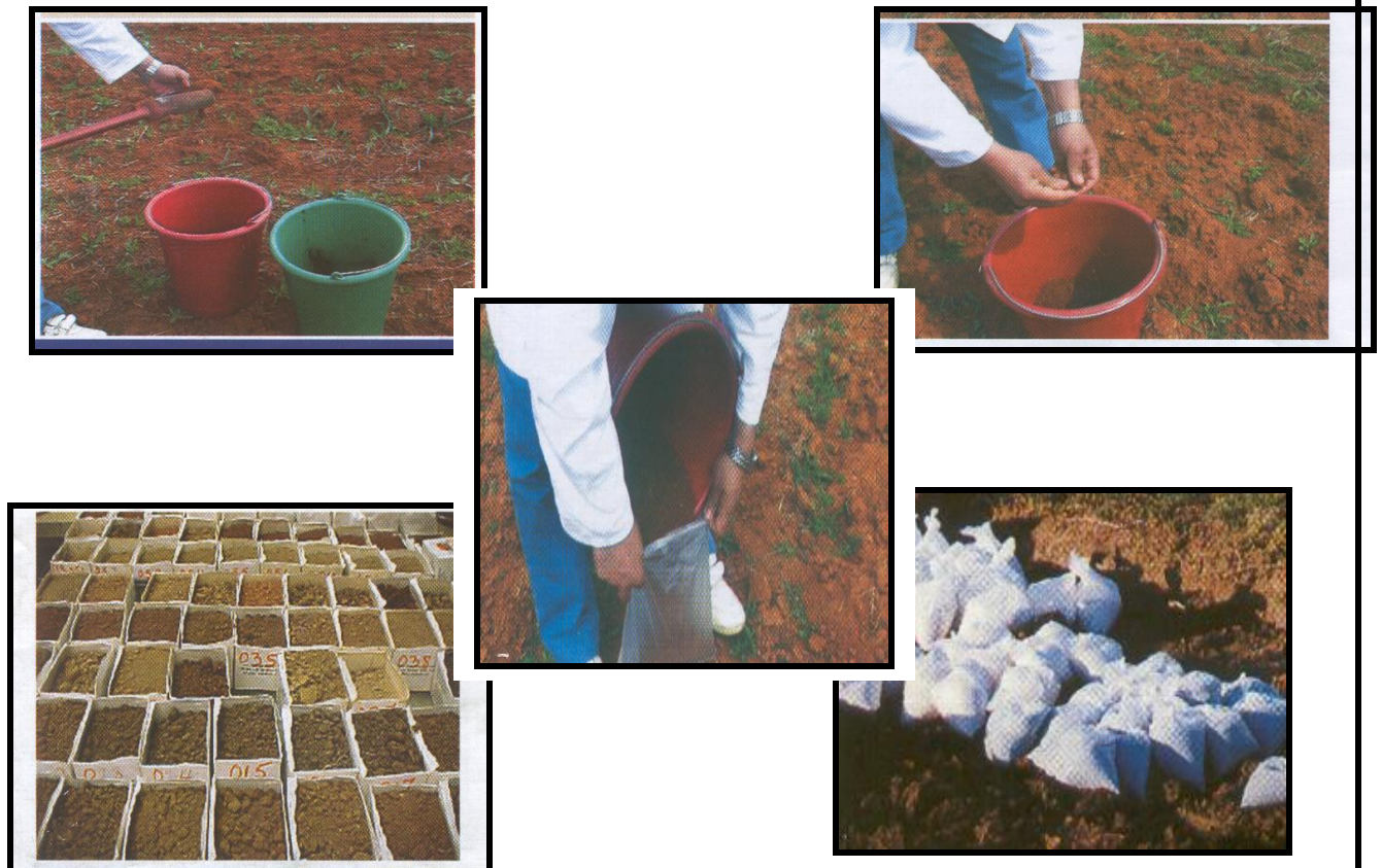
Figure I.9 : Les étapes de prélèvement conditionnement des échantillons de sols.
