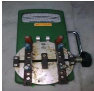
Figure 11 : torque-mètre
