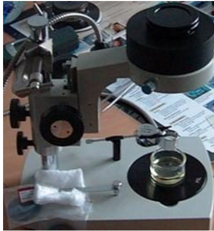
Fig. 10 : Illustration d'un polariscope (Source : www.geminterest.com )
