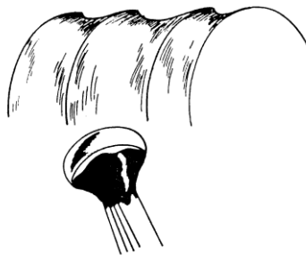
Fig. 21: Schéma d'une meule creuse pour cabochon
