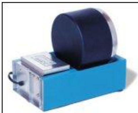
Fig.16 : Illustration d'un tonneau polisseur (Source : www.gemmes-info.com )
