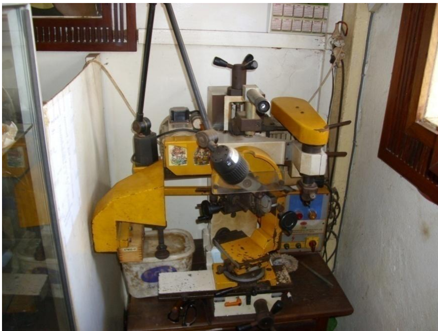
Fig. 24 : Outils de préformage des pierres et de façonnage de l'or chez un lapidaire informel à Nosy-Be hell ville (source : Auteur)
