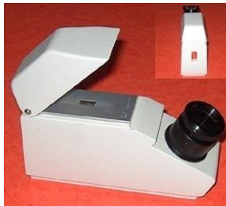
Fig. 12 : Illustration d'un réfractomètre (source : www.geminterest.com )
