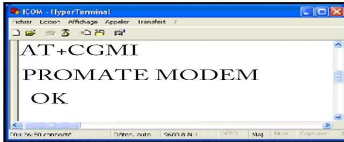
Figure 4.02 . Test de la marque du modem
