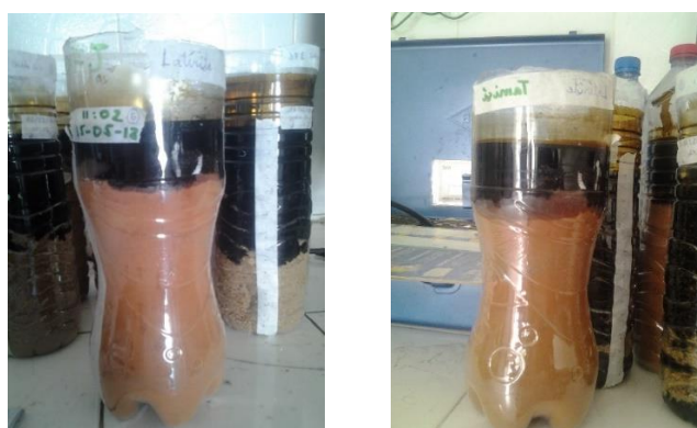
Figure 35 : Photographie de l'évolution de l'infiltration des déchets de fuel dans un sol latéritique tamisé
