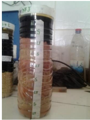
Figure 37 : Photographie de l'évolution de l'infiltration des déchets de fuel Enelec
