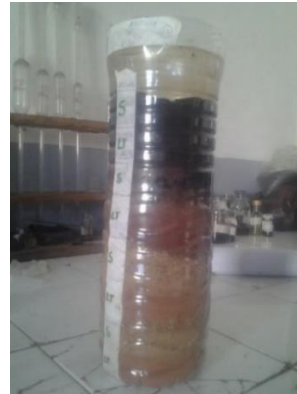
Figure 37 : Photographie de l'évolution de l'infiltration des déchets de fuel Enelec
