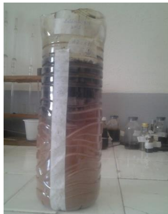
Figure 34 : Photographie de l'échantillon du déchet de fuel versé dans une bouteille coupée et remplie du sol latéritique non tamisé
