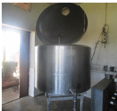
Photo 7: Tank à lait 800 Litres
