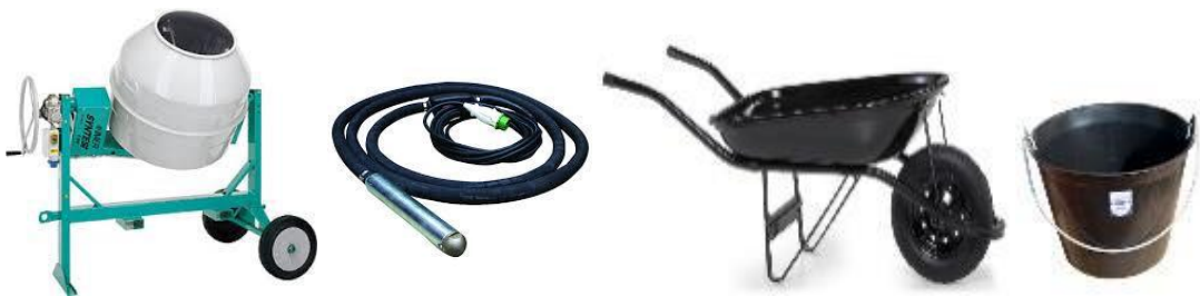
Figure 26: Les matériels de bétonnage.
