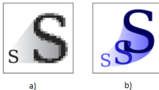
Figure 2. 14- Illustration d'une image bitmap a) agrandie avec de crénelage et une image vectorielle b) agrandie à l'infini (pas d'effet de pixellisation – crénelage)
