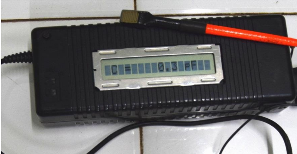
Figure 4. Cornéomètre, appareil utilisé pour mesurer la capacitance de la peau
