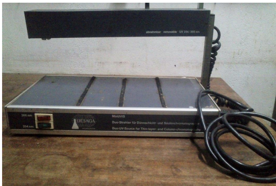
Figure 6. Lampe UV utilisé pour provoquer les rides
