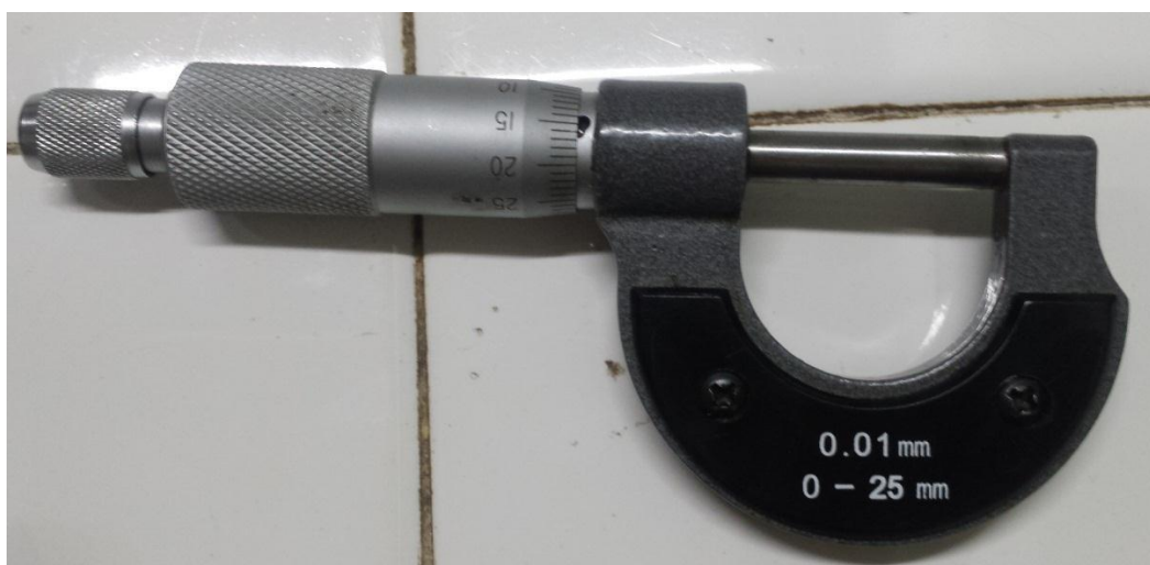
Figure 5. Palmer, appareil utilisé pour mesurer l'épaisseur de la peau
