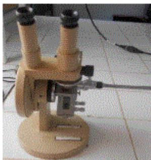
**Figure 5** : Réfractomètre KRÜSS OPTRONIC GERMANY
