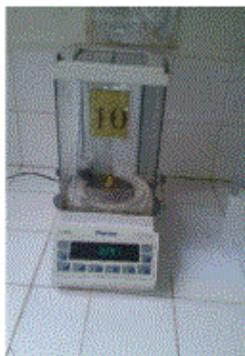
**Figure 4 :** Balance de mesure de la masse de l'HE
