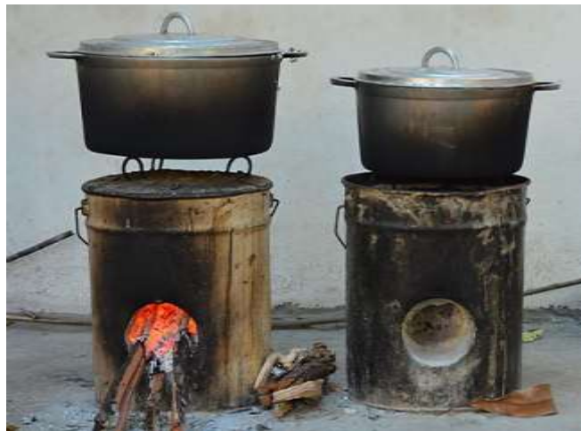
Figure 6 : Foyer performant «OLI-b» pour bois de chauffage
