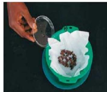
3. Placez ce sous échantillon sur le tamis pour extraction.
