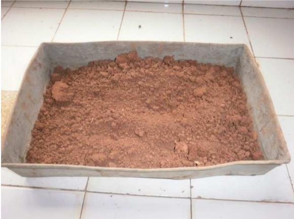
Photo20 : Séchage du sol homogénéisé
