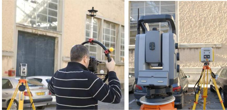
**Figure 50** Système de OMEGA, une méthode de référencement automatique d'image.
