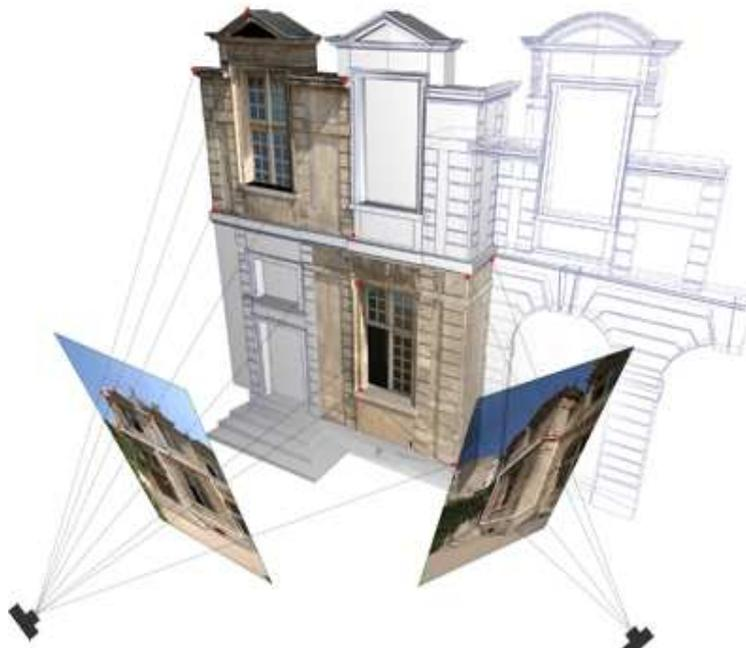
**Figure 47** Calibration et orientation des caméras
