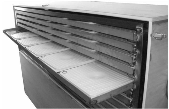
Figure 4. 4: Photographie de l'échangeur-stockeur fabriqué pour la maison Sumbiosi
