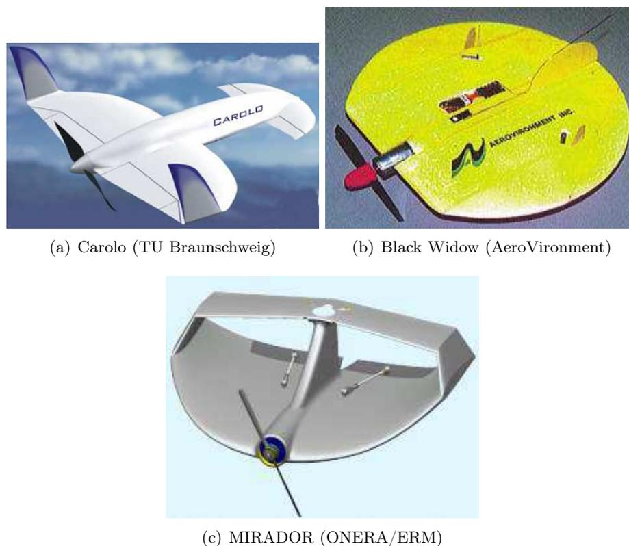
FIG. 1.34 – Quelques exemples de microdrones à voilure fixe
