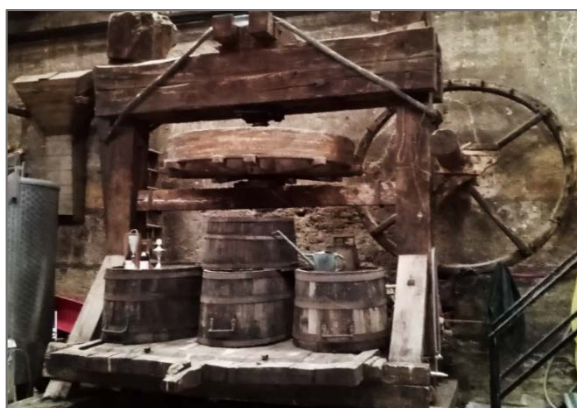
Figure 11 : Dernier pressoir "à écureuil" présent dans le cuvage de Vaurenard.
