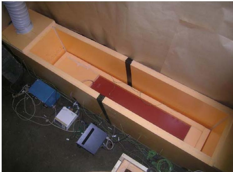
Figure 3.1 Cellule de caractérisation des échanges convectifs
