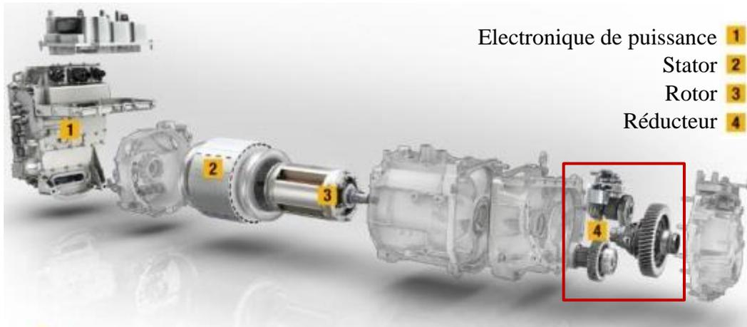
**Figure 3.1.** Groupe motopropulseur électrique (GMPé) développé par Renault. La partie étudiée est la partie gauche de l’encadré rouge.
