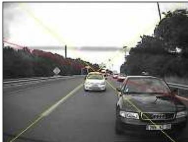
Figure 151 - Cas d'une ligne de marquage au sol occultée
