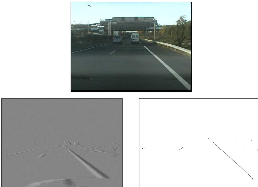
Figure 145 - Exemple de détection des centres de marquage
