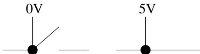
Ce sont des composants électroniques qui laissent passer un courant principal lorsque la tension sur le fil de commande est de 5V.
