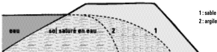
► Figure 7 : dimensionnement de la digue en fonction des infiltrations
