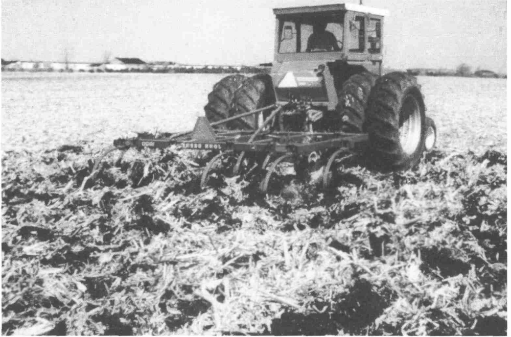
Figure 14.5. Préparation du sol avec le chisel.
