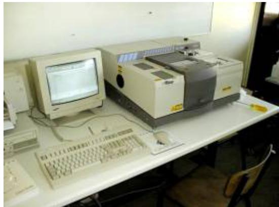
**Figure 19 :** Spectromètre AVATAR 320 FT-IR
