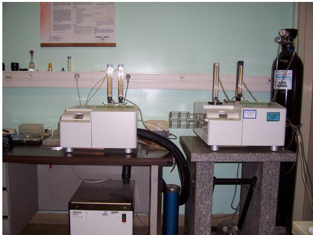
**Figure 14** : Appareil de mesure par analyse calorimétrique différentielle
