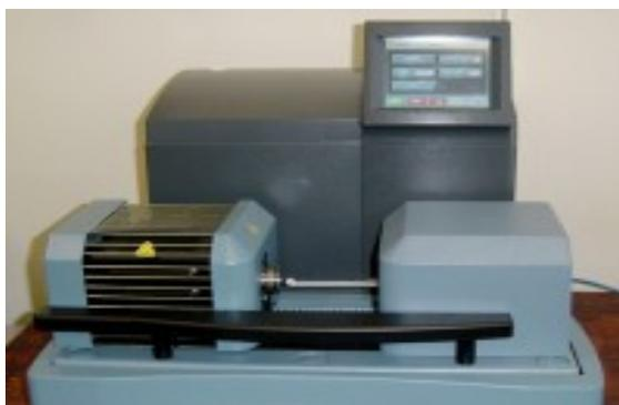
**Figure 13 :** Appareil d'analyse thermique « SDT Q600 instrument »
