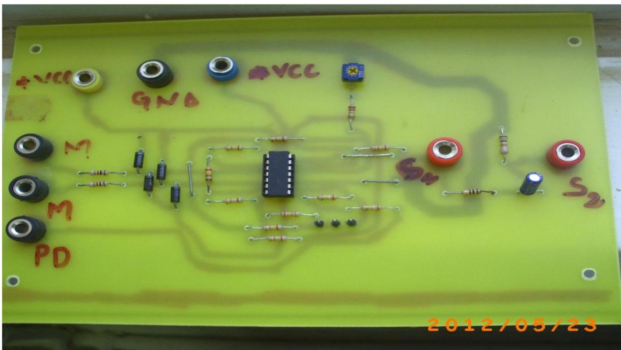
Figure 29 : Amplificateur d'instrumentation.
