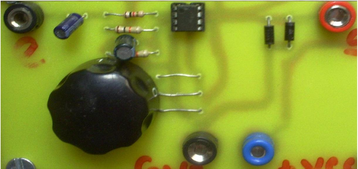
Figure 35 : l'abaisseur de tension.
