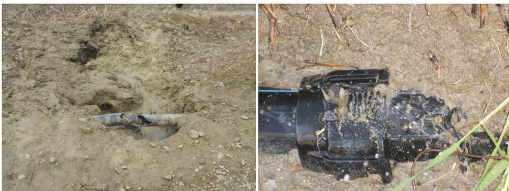
**Figure 20 : Informations sur la déformation des conduites (PVC, EPHD-2013)**
