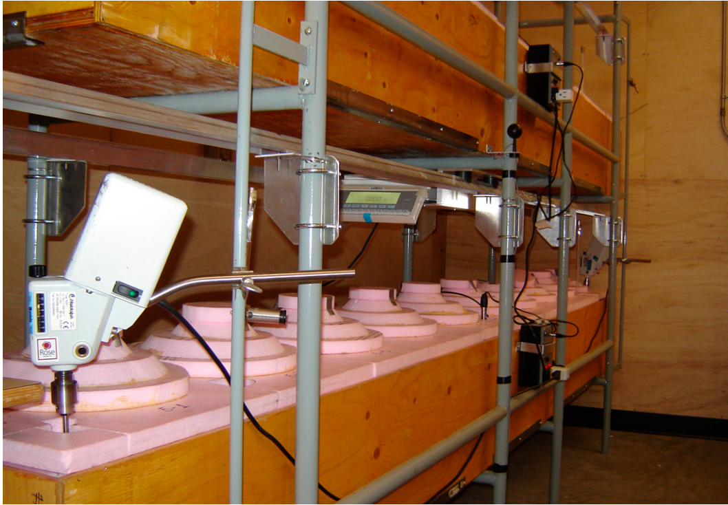
Figure 18. Bassin de sorption à température constante à 25°C (une couche isolante thermofoil couvrait ce système).
