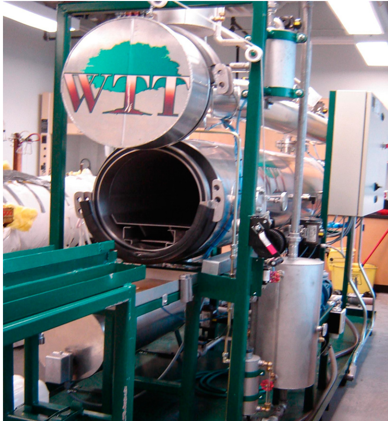
Figure 17. Cylindre utilisé pour la saturation des échantillons destinés aux essais sur la membrane poreuse.
