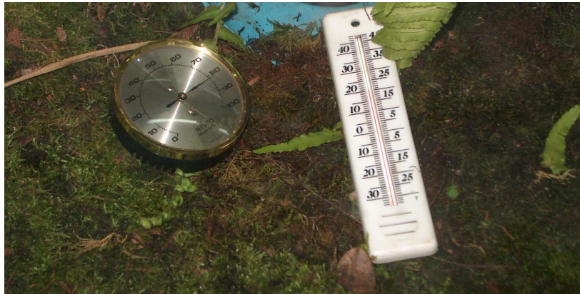
Figure 7 : Hygromètre (à gauche) et Thermomètre (à droite) (Razanadravoninirina, 2004).
